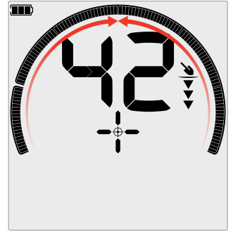
สัญญาณวัตถุเป้าหมายที่แรงที่สุด: เปิดเซกเมนต์ความสามารถในการคัดแยกโลหะทั้งหมด วัตถุเป้าหมายจะตั้งอยู่ที่เส้นกึ่งกลางของขดลวดโดยตรง
